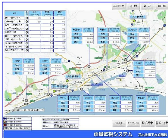
雨量監視システム
